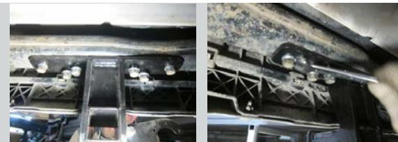
**ШАГ 4.** Установите кронштейн розетки и закрепите его на шпильке с помощью гайки M10 через шайбу M10 увеличенную и шайбу M10 пружинную.
