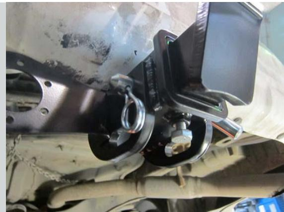
Тип соединения: шаровый; Диаметр сцепного шара: 50 мм.; Масса комплекта ТСУ 08031501: 9,5 кг.
