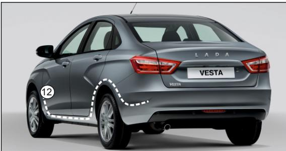
15. Демонтируйте декоративные обшивки порогов водительской стороны салона а/м. Уложите соединительный кабель питания блока управления (12) вдоль штатной проводки а/м в направлении левой части торпеды, фиксируя пластиковыми стяжками по всей длине кабеля с промежутками 150-200 мм.
