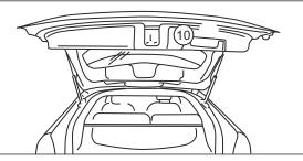
26. Выберите место для установки задней кнопки (10) из к-та. Используя фрезу (21) просверлите отверстие. Установите кнопку управления в сформированное отверстие в обшивке багажника.
