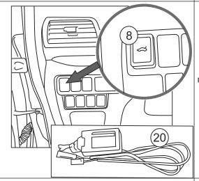
19. Установите переднюю кнопку (8) вместо штатной заглушки, подключив к ней разъем кабеля блока управления (20).
