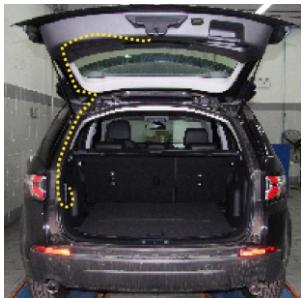
10 Уложите питающий кабель вдоль штатной проводки а/м в направлении задней двери, фиксируя пластиковыми стяжками по всей длине кабеля с промежутками 150-200 мм.
