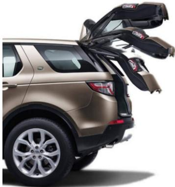
**ВНИМАНИЕ!** Перед выполнением работ убедитесь, что при закрытых боковых дверях с поднятыми в них стеклами, крышка задней двери закрывается без прикладывания усилий. В противном случае необходимо её отрегулировать.
