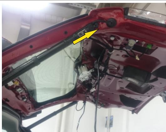
6. Присоедините электроприводы, соблюдая маркировку «L» и «R», к установленным шарообразным кронштейнам, таким образом, чтобы место из которого выходит кабель находилось ближе к кронштейну расположенному на двери.
