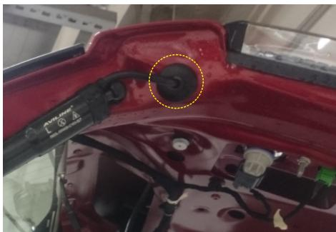
13. Для подключения звукового излучателя используйте кабель соответствующий разъему (B) блока управления. Установите звуковой излучатель, закрепив его на металлической части двери.
