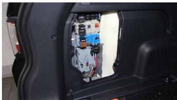
9. В левом заднем крыле откройте отсек с блоком предохранителей. Произведите подключение питающего кабеля у блока предохранителей, со стороны водителя в следующем порядке:
