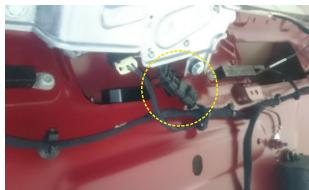
12.Через проходные разъемы кабеля, предназначенного для разъема (D) блока управления, подключите разъемы кабелей штатной кнопки открытия и замка задней двери.
