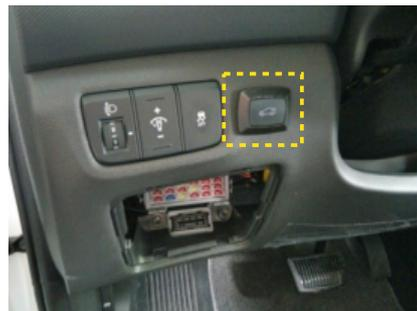
10. Используя из комплекта фрезу просверлите отверстие в торпедо для кнопки управления. Установите кнопку управления в сформированное отверстие. Подключите соответствующий разъем питающего кабеля к кнопке управления.
