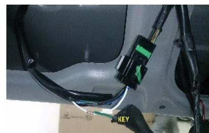
14. При не совпадении разъема, для подключения к штатной кнопке открытия задней двери, подключите ЗЕЛЕНый провод к белому проводу штатной кнопки открытия замка задней двери. (на проводе должна появляться масса при нажатии кнопки)
