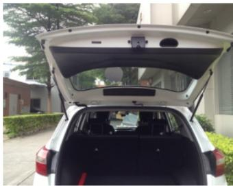
**ВНИМАНИЕ!** Перед выполнением работ убедитесь, что при закрытых боковых дверях с поднятыми в них стеклах, крышка задней двери закрывается без прикладывания усилий. В противном случае необходимо её отрегулировать.
