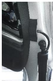
18. Установите на место декоративную обшивку двери и определите местоположение кабелей электроприводов. Для них необходимо сделать вырезы округлой формы в декоративной обшивке задней двери и установить на кабели резиновые адаптеры из комплекта поставки. После чего приклейте эти адаптеры на металлическую поверхность двери при помощи двухсторонней клейкой ленты.
