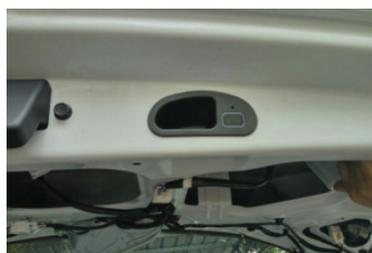
15. Замените штатную ручку закрывания задней двери на ручку (с кнопкой) из комплекта поставки, затем подключите к ней соответствующий разъем проводки блока управления.
