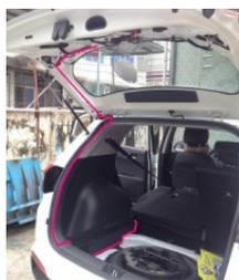
11. Демонтируйте декоративные обшивки порогов водительской стороны салона а/м. Уложите питающий кабель вдоль штатной проводки а/м в направлении задней двери, фиксируя пластиковыми стяжками по всей длине кабеля с промежутками 150-200 мм.
